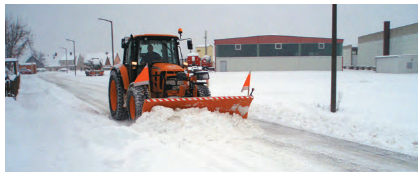
bema Schneeschild Serie 700, Schlepper (Dreipunktbock)
