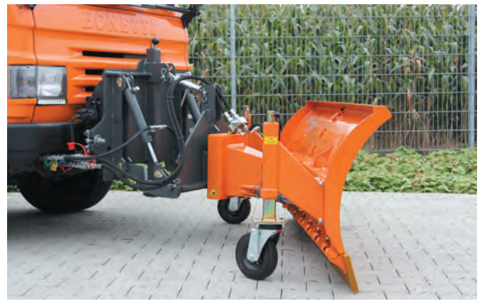
bema Schneeschild Serie 700 mit Hubeinrichtung für Winterdienstplatte
